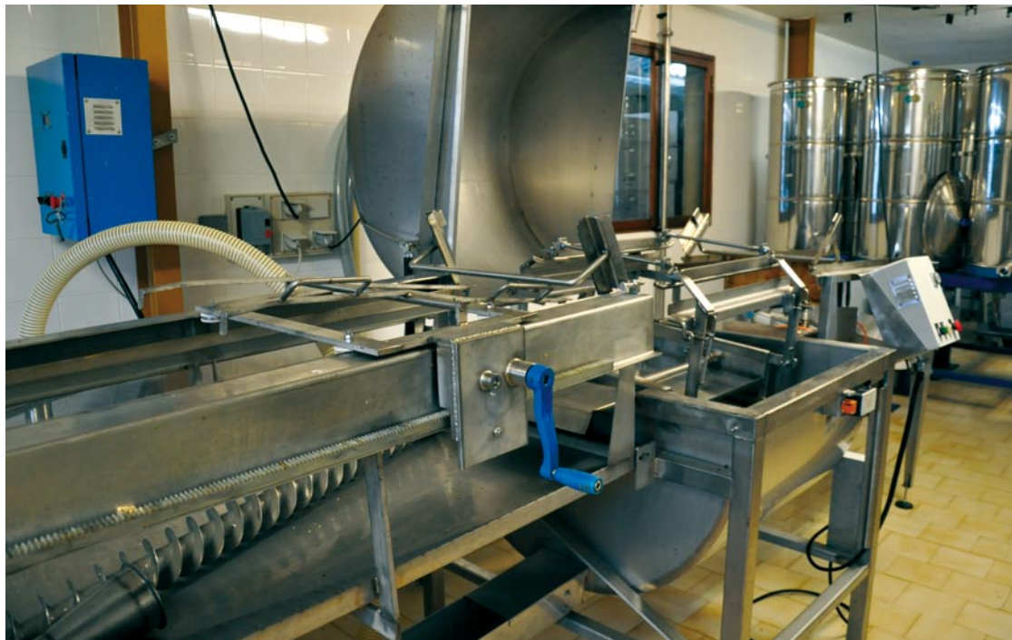
Figura 4. Linea automatica di smielatura (veduta parziale)
