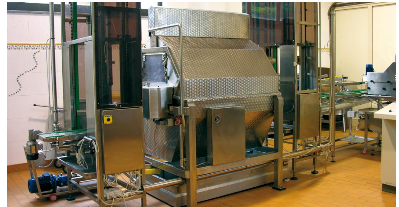
Figura 5. Linea di smielatura automatica (veduta parziale)
